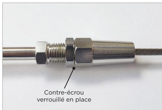
D3. Tournez le contre-écrou dans le sens contraire des aiguilles d'une montre à l'aide d'une clé de 12 mm pour verrouiller le cône de serrage en place.
